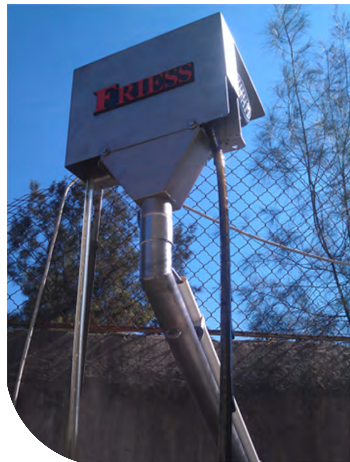
Déshuileur en fonctionnement. L'huile est récupérée d'un côté, raclée dans l'écumoire et le tube propre descend de l'autre côté.
