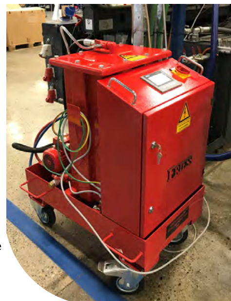
Elektrostatische Ölreinigungsanlage D8 in Betrieb
