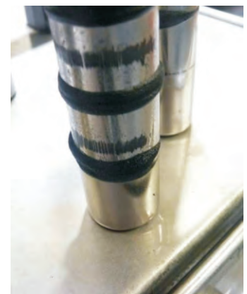
Feinstabrieb auf Magnetfilterstäben
