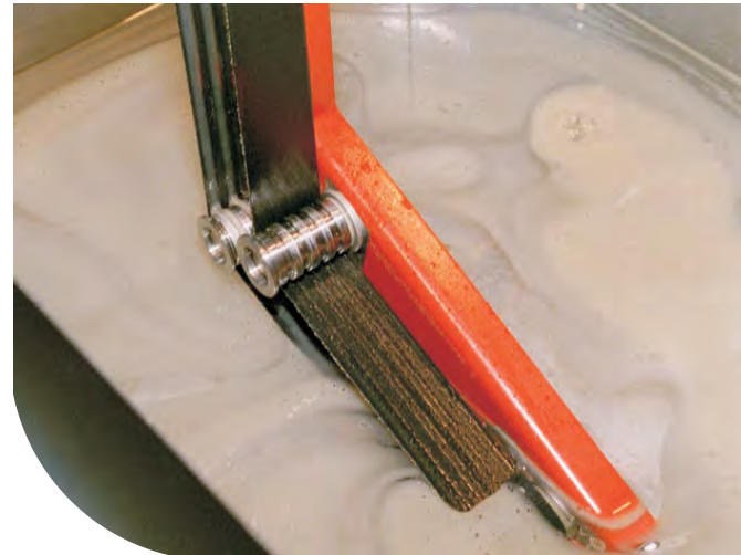
Das Skimmerband zieht das Öl durch Bewegung der Oberfläche an
