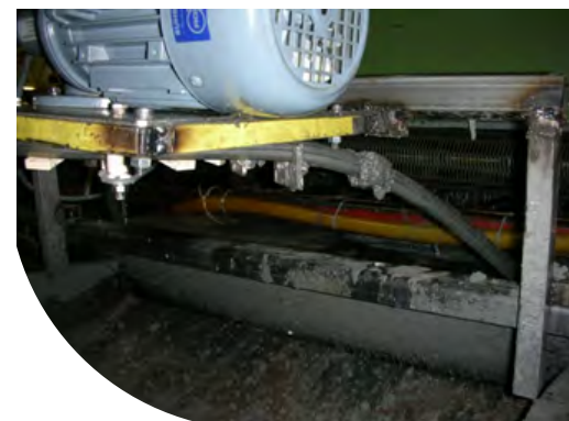
Ölskimmer mit eingebauten Magneten
