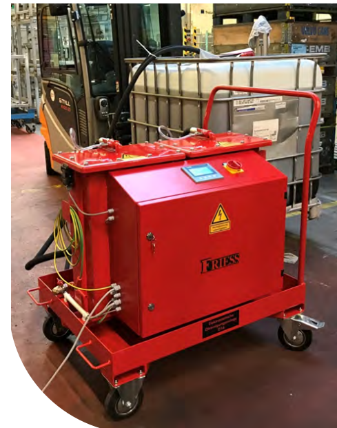
Elektrostatische Ölreinigungsanlage D16 in Betrieb
