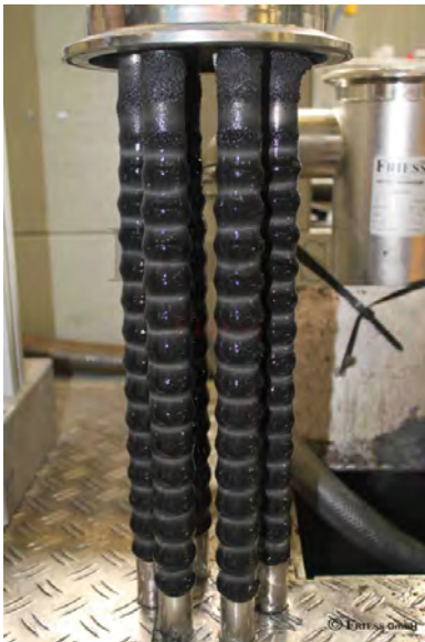
1) kontaminierte Magnetfilterstäbe 2) Arbeitsprinzip Magnetfilterstab
