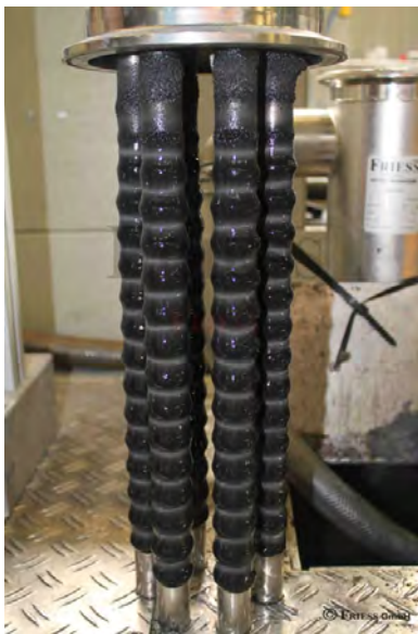
1) Kontaminierte Magnetfilterstäbe 2) Arbeitsprinzip Magnetfilterstab
