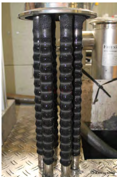
1) Kontaminierte Magnetfilterstäbe 2) Arbeitsprinzip Magnetfilterstab
