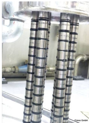
Feinstverschmutzung auf Magnetfilterstäben
