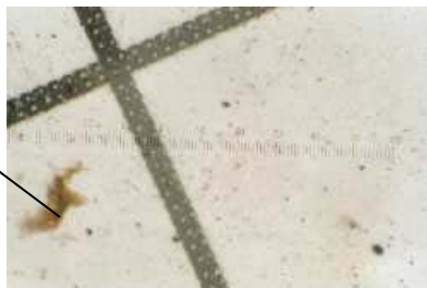
Gefilterte Ölprobe mit Verharzung
